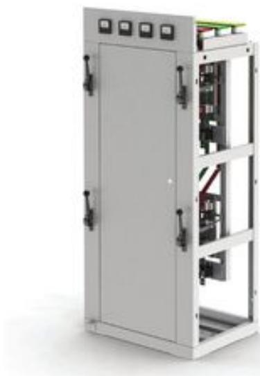
Панели распределительные серии ЩО-70 УЗ предназначены для комплектования щитов распределительных устройств трехфазного переменного тока напряжением 380/220 В частотой 50 Гц для сетей с глухозаземленной или изолированной нейтралью.
