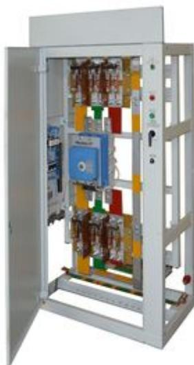
Секционные панели используются только в распределительных устройствах двухтрансформаторных подстанций. Коммутирующее устройство (рубильник, автоматический выключатель, система АВР), установленное в секционной панели, в случае выхода из строя или вывода в ремонт одного из силовых трансформаторов, должно подключить вторую секцию ко второму трансформатору.
